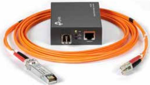
**Uns diente ein Modell von TP-Link als LAN-auf-SFP-Übersetzer. Die dünnen Glasfaserstrippen sind optimal für die heimische Festinstallation.**
